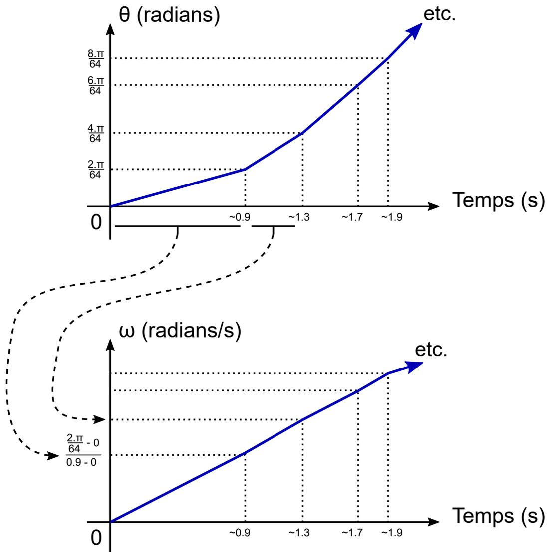
**Question 2. b.** Est-il possible, avec ce capteur, de connaître l'angle  $\theta$  à l'instant initial ? Est-il possible de connaître le sens de rotation du disque ?
