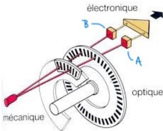
Les signaux  $A$  et  $B$  seront, bien souvent, décalés d'un quart de période. Dans un sens de rotation (sens 1), le signal  $B$  sera en avance sur le signal  $A$ . Dans l'autre sens, le signal  $B$  sera en retard (voir figure ci-dessous qui représente  $A$  et  $B$  en fonction du temps).
