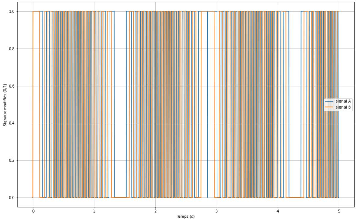
Une manière de détecter le sens de rotation est, par exemple, d'analyser l'état du signal *B* lors d'un front montant ou descendant du signal *A*.
