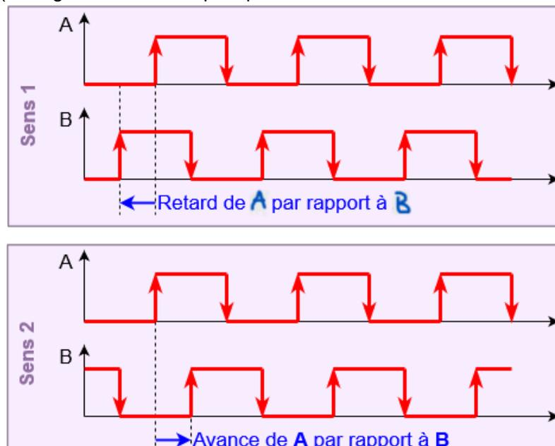
**Question 10.** Quel sera le plus petit angle (en radians) mesurable avec un codeur incrémental de  $n_f$  fentes, muni de 2 voies de mesure, et pour lequel on détecte les fronts montants et descendants ?
