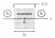
La température du milieu extérieur,  $T_0$  est constante. La température d'interface est notée  $T_s(t)=T(-e,t)=T(e,t)$ . Les échanges thermiques au niveau des interfaces sont modélisés par la loi de Newton. La puissance sortant latéralement de la nourriture fait intervenir le coefficient d'échange g:
