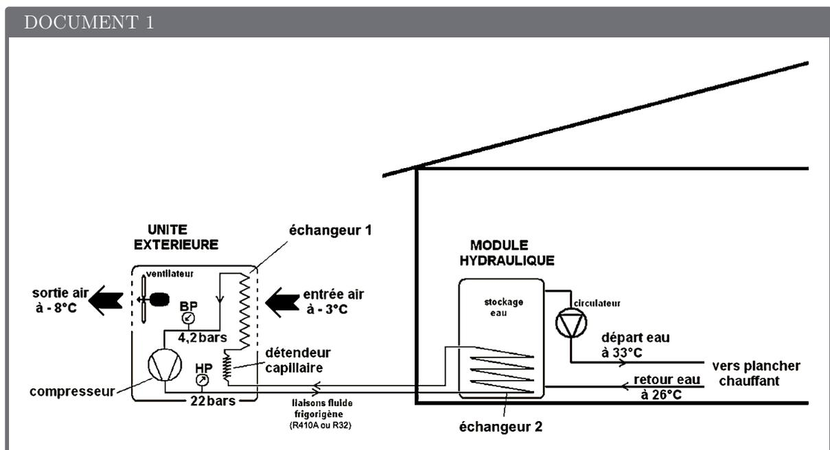
7. À l'aide du Document 1, identifier la source chaude et la source froide ainsi que le système mécanique qui échange un travail avec le fluide de la pompe à chaleur.
