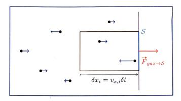
On suppose que les particules possèdent une vitesse égale à la **vitesse quadratique**  $u=\sqrt{\sum_i v_{x,i}^2}$ , avec  $v_{x,i}$  la vitesse de la particule i. Sa quantité de mouvement  $\overrightarrow{p_0}$  vaut alors  $m\overrightarrow{u}$ .
