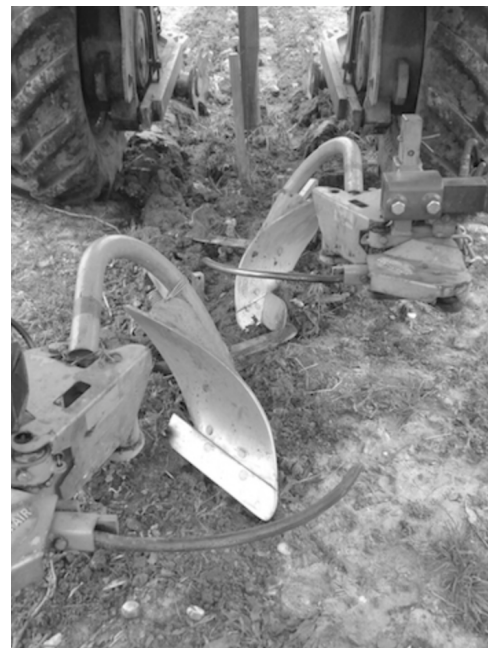
Figure 2 Lames décavaillonneuses interceps équipant un enjambeur
