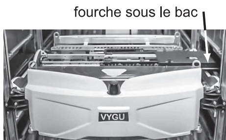
Figure 5 - Prise d'un bac (fourche sous le bac dans un rack)
