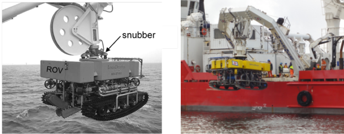
Figure 3: Présentation du snubber
