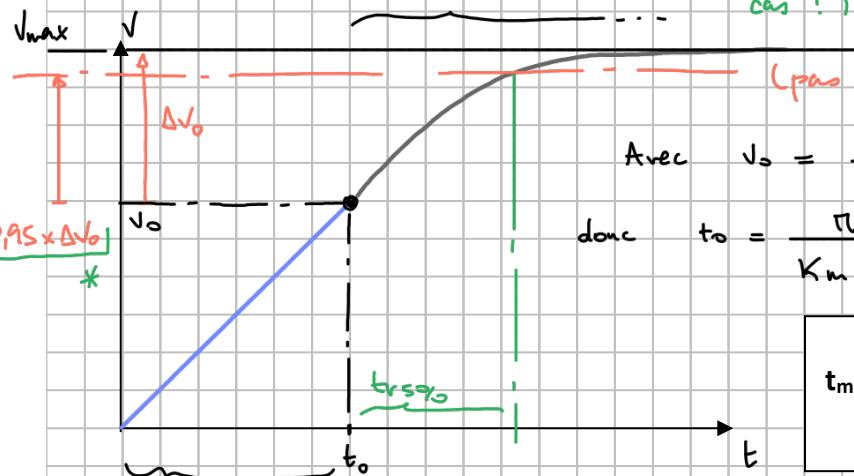
$$\text{Avec } V_0 = \frac{1}{n_{\text{eq}}} \cdot (K_m \cdot \frac{n}{R} \cdot I_0 - F_0) \cdot t_0$$
