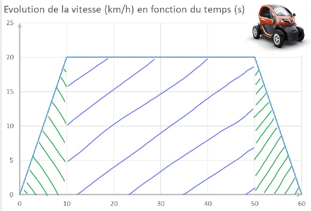
$$d = \int_{t=0}^{60} v(t) \cdot dt = \text{aire sous la courbe} = 20 \frac{\text{km}}{\text{h}} \cdot (10 \text{ s}) + 20 \frac{\text{km}}{\text{h}} \cdot (40 \text{ s})$$
