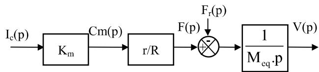
**Question 17** En utilisant le schéma bloc précédent, calculer  $V(p)$  en fonction de  $I_c(p)$  et  $F_r(p)$  puis en utilisant le tableau fourni en **Annexe 7**, déterminer l'équation de la vitesse  $v(t)$  du véhicule dans le cas où  $i_c(t)$  et  $F_r(t)$  sont des échelons respectivement d'amplitude  $I_0$  et  $F_0$ .
