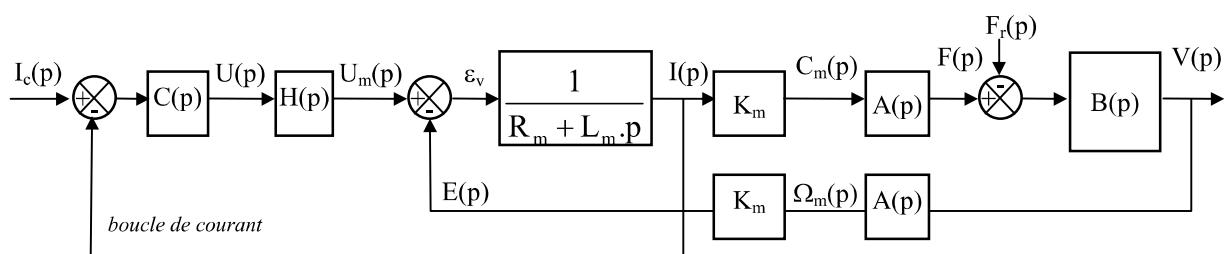
Avec :  $C(p) = R_m \left(1 + \frac{R_m}{L_m p}\right)$  le correcteur PI de la boucle de courant.
