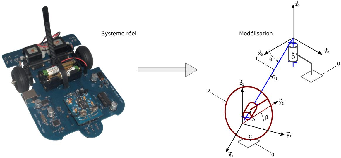
Les deux roues peuvent être commandées séparément. On se place dans le cas particulier où une seule roue est mise en rotation.
