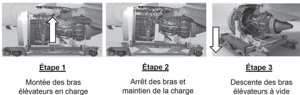
Figure 5 – Etape pour la pose d'un moteur
