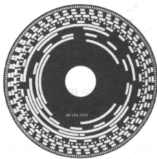
Disque avec codage absolu 12 pistes
