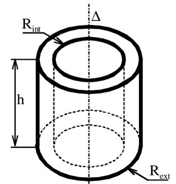
Sachant que la masse  $m$  d'un cylindre creux homogène de rayon extérieur  $R_{ext}$  de rayon intérieur  $R_{int}$  de hauteur  $h$  et de masse volumique  $\rho$  est :
