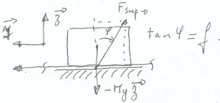
L'application du TRD au produit à l'angle de l'inclinaison en projection sur  $\vec{z}$  donne  $-M_p g + \overrightarrow{F_{sup-tapis}} \cdot \vec{z} = 0$
