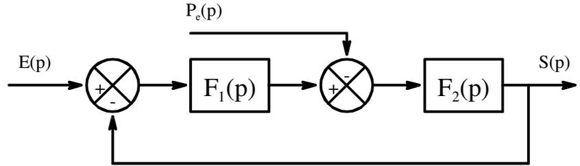
Les fonctions de transfert  $F_1(p)$  et  $F_2(p)$  sont respectivement un premier ordre simple de gain  $K_1$  et de constante  $\tau_1$  et un intégrateur de gain  $K_2$ .
