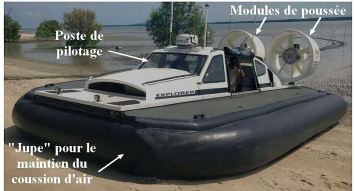
La motorisation du modèle étudié (Griffon Hoverwork 995E) est assurée par un moteur diesel qui fournit l'énergie électrique. Cependant, les manœuvres et la propulsion sont réalisées par 2 modules de poussée électriques et orientables. Ce qui confère à ce véhicule de grandes qualités de manœuvrabilité.
