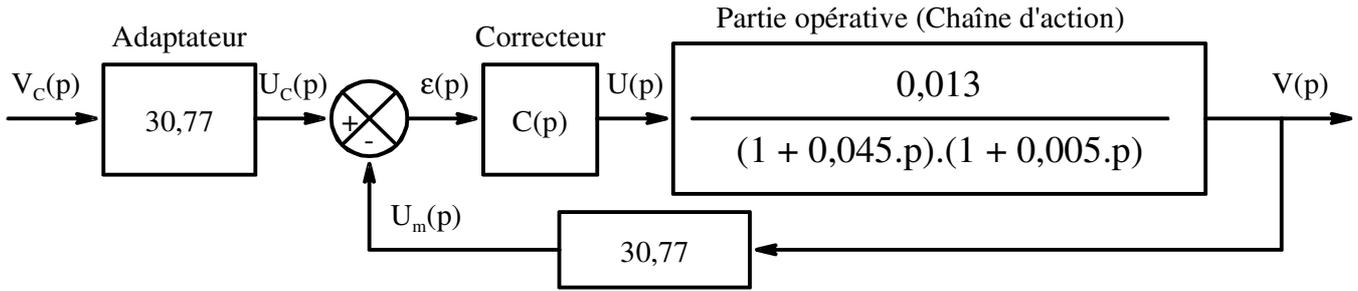
D'autre part les deux gains avant le comparateur étant identiques, il est possible de les remplacer par un seul bloc (de même gain) après le comparateur. Qui peut être placé après celui du correcteur. La FTBO non corrigée a donc un gain de  $30,77 \times 0,013 = 0,4$
