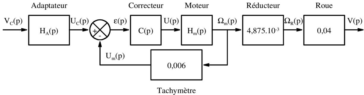
**Remarques:** ☞ La roue roulant sans glisser sur le sol :  $v(t) = R_{roue} \cdot \omega_R(t)$  où  $R_{roue}$  est le rayon de la roue. Le gain de la roue est donc égal à son rayon.
