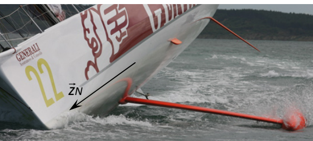
Figure 6 : Voilier avec sa quille pendulaire écartée au maximum sur « bâbord »
