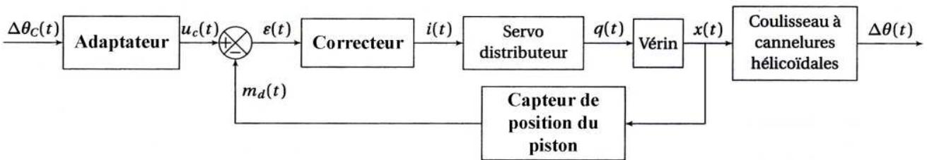
La consigne de position angulaire de l'arbre à cames  $\Delta\theta_C(t)$  est donnée par le calculateur du moteur. A partir de cette consigne  $\Delta\theta_C(t)$ , l'adaptateur délivre une tension  $u_C(t)$  (avec un gain  $K_A$ ) qui est comparée à la tension  $m_d(t)$  issue du capteur de position du piston qui est un gain pur  $K_C$ .
