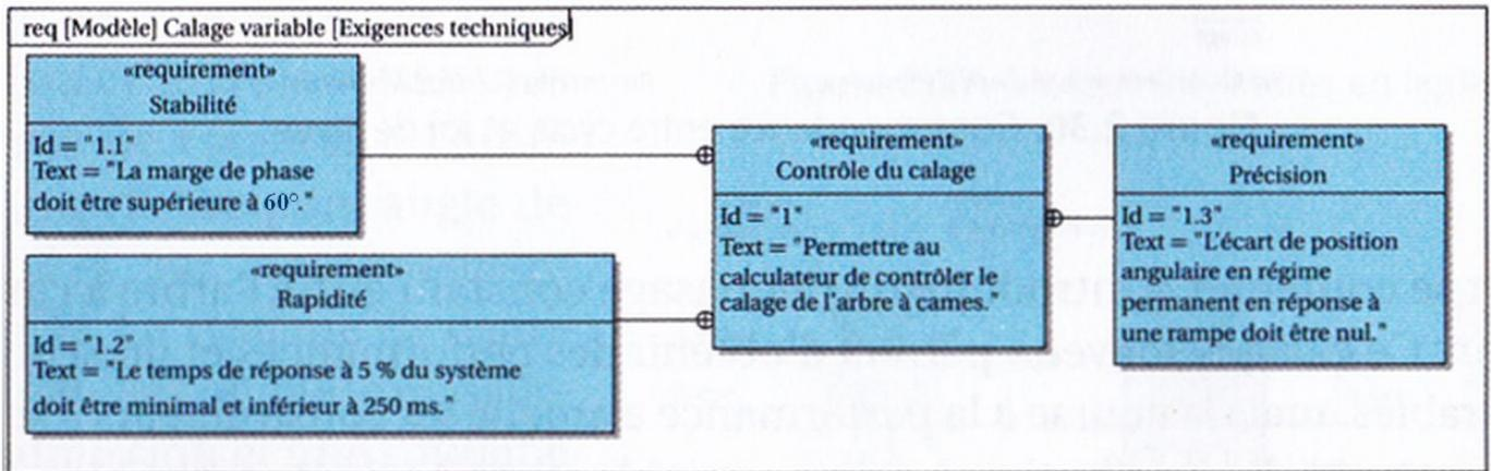
Pour respecter le critère de rapidité, on estime que ω<sub>0dB</sub> la pulsation de coupure à 0dB de la FTBO doit être au minimum de 30 rad.s<sup>-1</sup> : ω<sub>0dB</sub> ≥ 30 rad.s<sup>-1</sup>.
