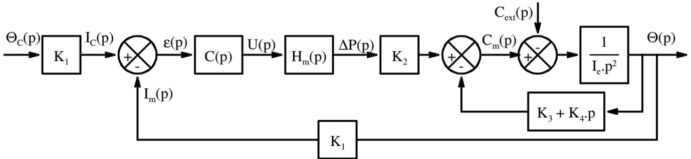
1.2- Le schéma bloc ci-dessus est équivalent au schéma bloc à retour unitaire ci-dessous. On a pour cela passé les gains K1 après le comparateur de gauche et permutés les deux comparateurs de droite.
