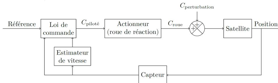
**Figure 10** Architecture du système SCAO
