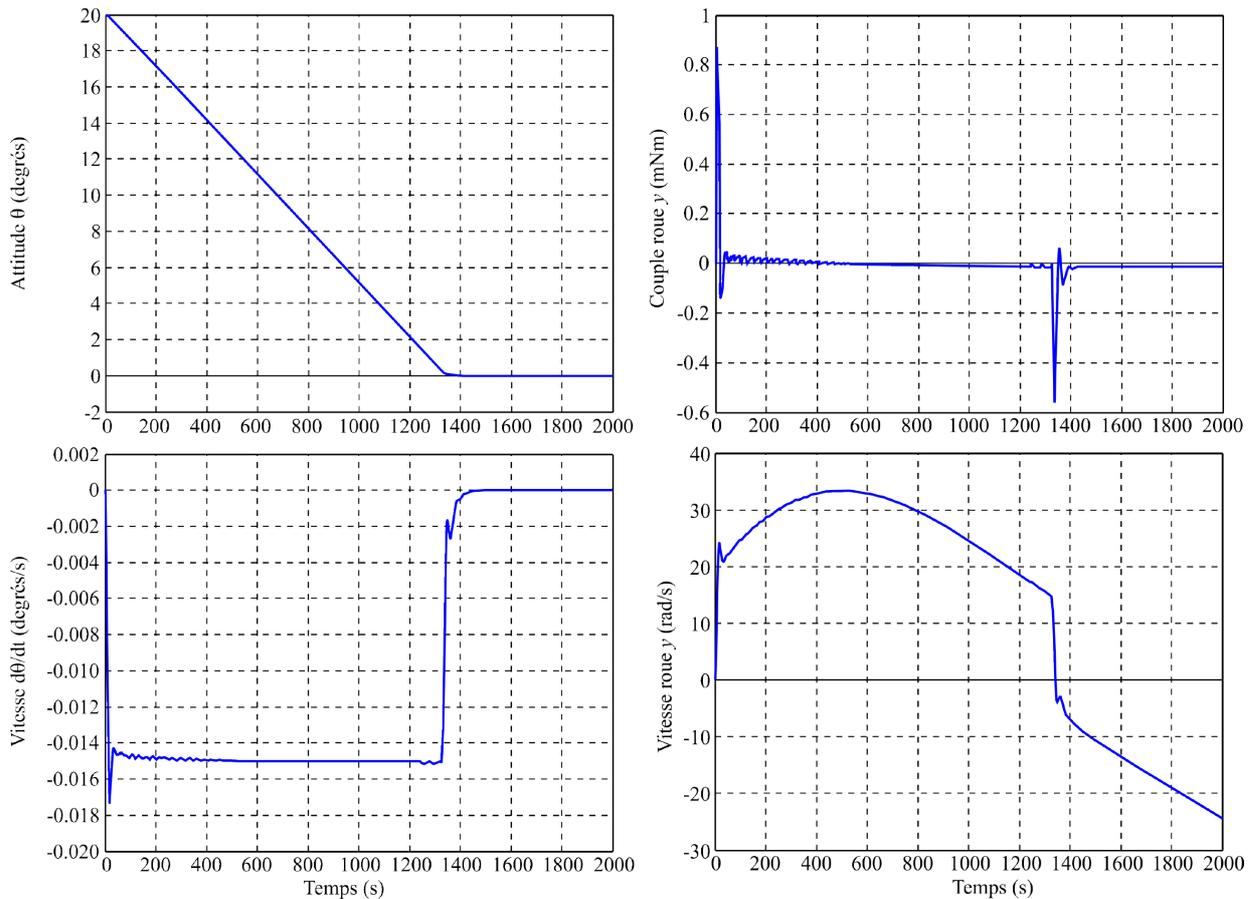
**Figure 14** Évolutions temporelles à partir d'une condition initiale (dépointage)  $\theta_0 = 20^\circ$
