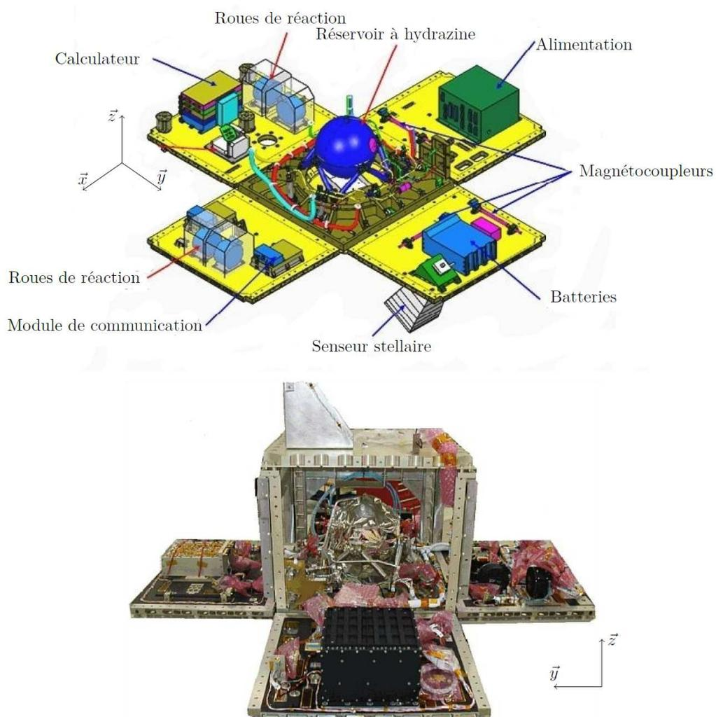
**Figure 2** Plateforme Myriade (panneaux latéraux dépliés)
