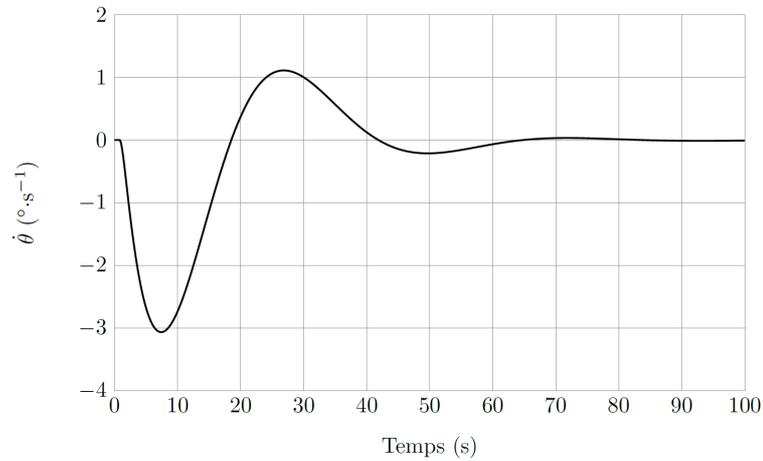
**Figure 13** Évolution de la vitesse de rotation du satellite  $\dot{\theta}$  ( $^\circ \cdot s^{-1}$ ) en réponse à un dépointage initial de  $20^\circ$
