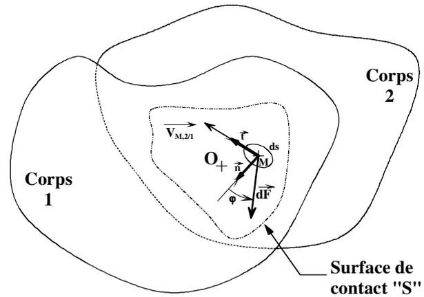
Si le contact se fait avec frottement de coefficient  $\mu = \tan \varphi$  alors cette force  $\vec{dF}$  est définie par :
