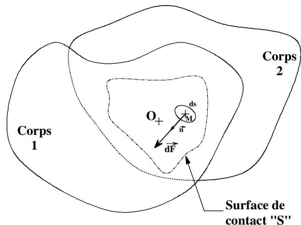
La force élémentaire de 1 sur 2 est orientée de 1 vers 2. Inversement pour l'action de 2 sur 1.
