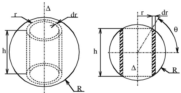
Tous les volumes élémentaires  $dv$  de masse  $dm = \rho \cdot dv$  sont constitués de points équidistants de l'axe  $\Delta$ . Cette distance étant  $r$ , on en déduit pour ce cylindre le moment d'inertie par rapport à l'axe  $\Delta$  :
