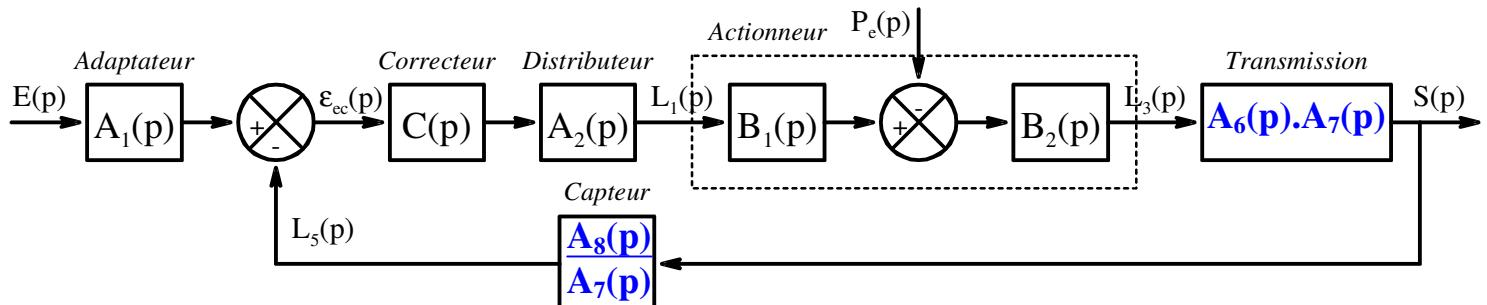
En général, la boucle de retour est un gain pur :  $\frac{A_8(p)}{A_7(p)} = C^{\text{te}}$ . Et on a un fonctionnement normale de l'asservissement :  $\varepsilon_{\text{EC}}(p) = 0$  pour  $S(p) = E(p)$
