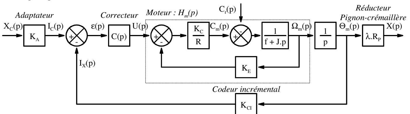
$C_r(t)$  est le couple résistant. On prendra  $C_r(t) = C_{r0} = 1 \text{ N.mm}$
