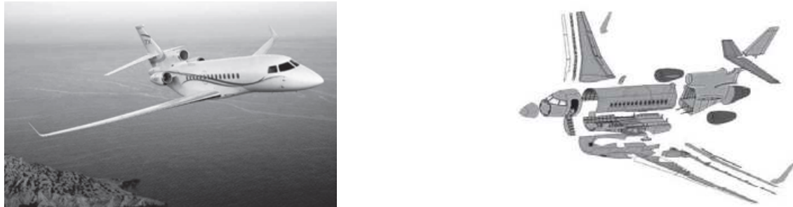
Figure 2 : FALCON 7X et vue éclatée des différents sous-ensembles d'un FALCON 7X
