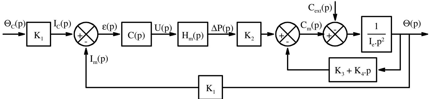
**1.2-** Le schéma bloc ci-dessus est équivalent au schéma bloc à retour unitaire ci-dessous. On a pour cela passé les gains  $K_1$  après le comparateur de gauche et permuted les deux comparateurs de droite.
