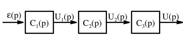
$$\text{Avec : } C_1(p) = C_2(p) = \frac{1 + 0,26.p}{1 + 0,06.p}$$
