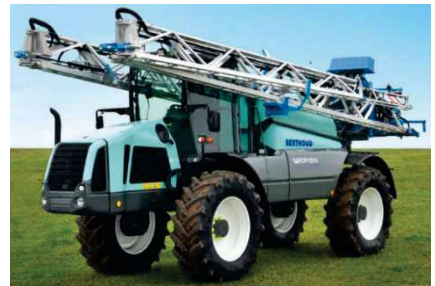
Photo 2 : modèle RAPTOR avec sa rampe de type « Axiale » repliée
