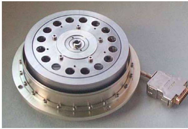
Figure 6 Roue de réaction (carter ouvert)
