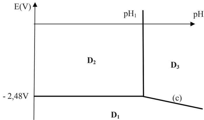
**Figure 3** - Diagramme E-pH du magnésium
