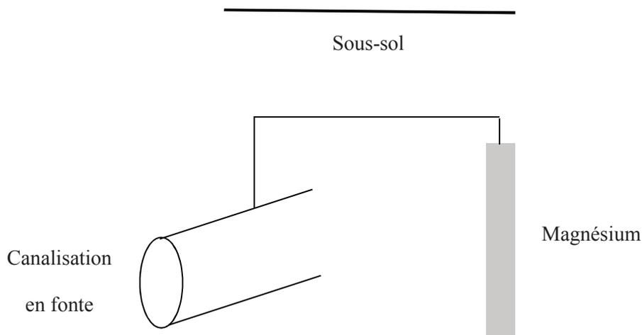
**Figure 4** - Canalisation en fonte et anode sacrificielle
