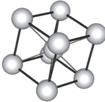
**Figure 1** - Structure cubique centrée
