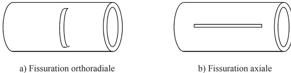
**Figure 6 - Tube fissuré**
