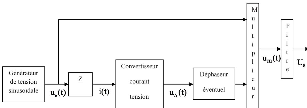
**Figure 8** - Synoptique global du dispositif à détection synchrone
