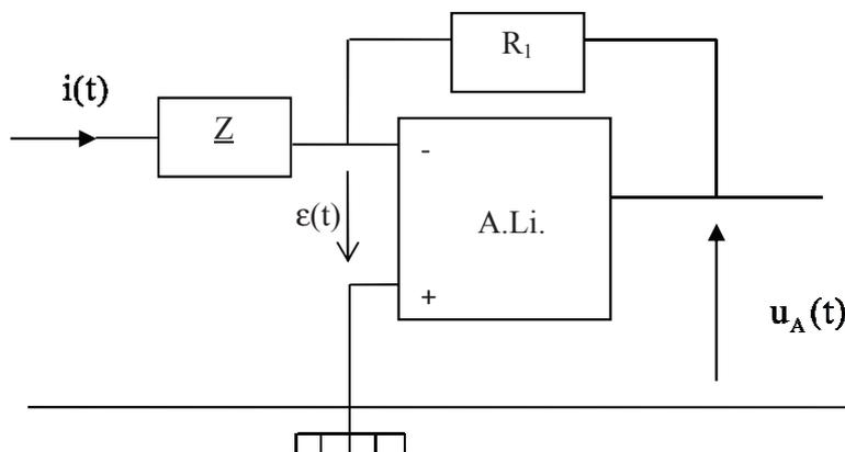
**Figure 9** - Convertisseur courant-tension
