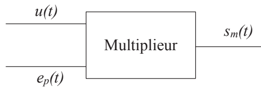
Figure 9 – Multiplication de l'onde porteuse et signal modulé
