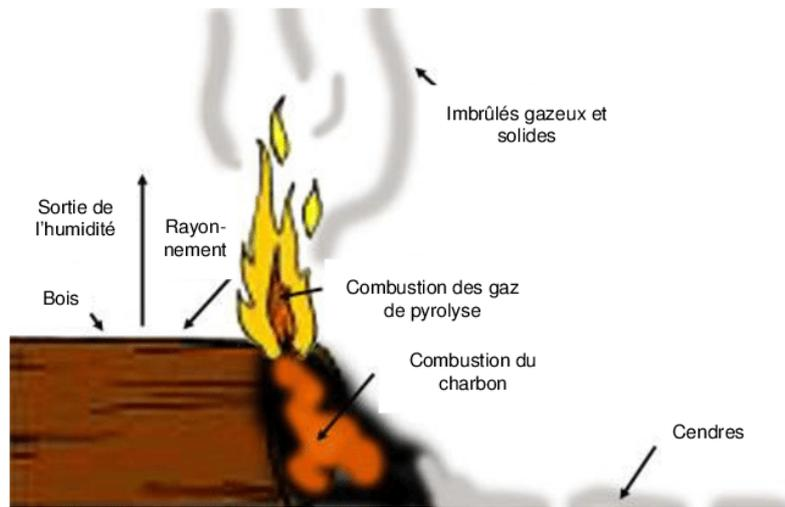
**Figure 1** Différentes phases de combustion du bois<sup>1</sup>
