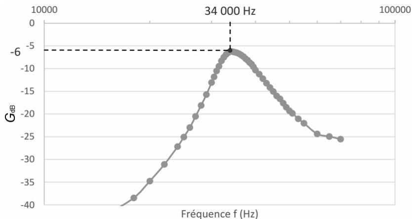
FIGURE 15 – Diagramme de Bode en gain expérimental : évolution du gain en décibels en fonction de la fréquence.
