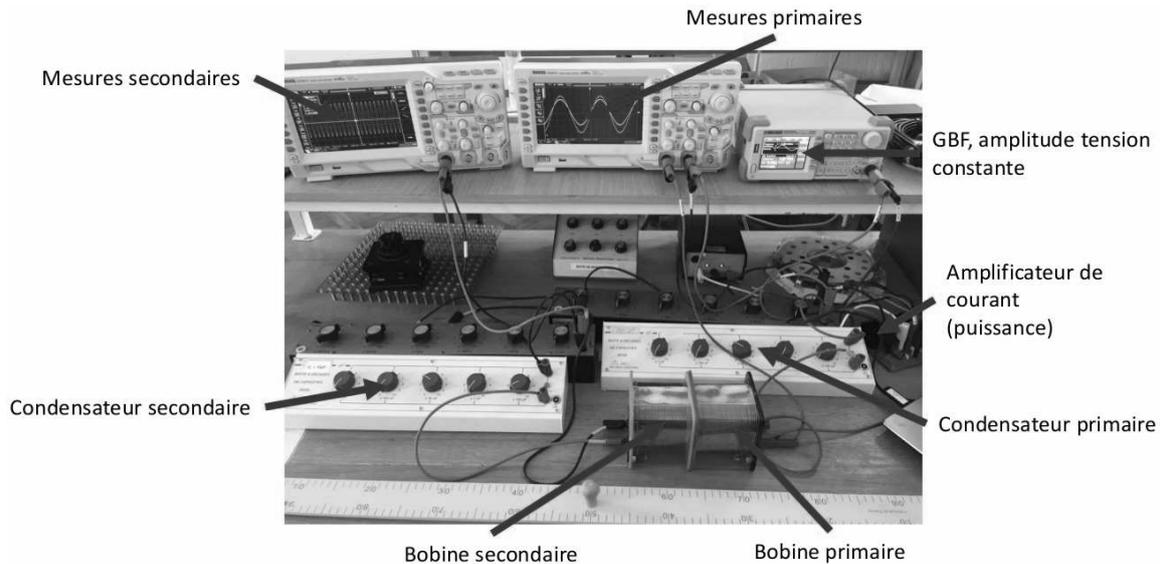
FIGURE 14 – Photographie légendée du montage expérimental.
