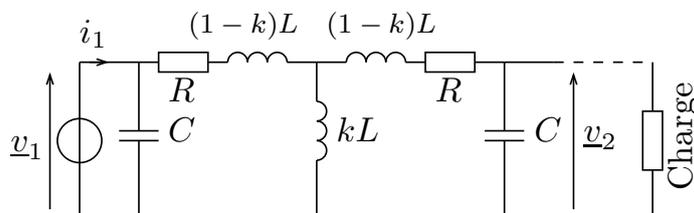
FIGURE 12 – Circuit électrique équivalent ramené au primaire.
