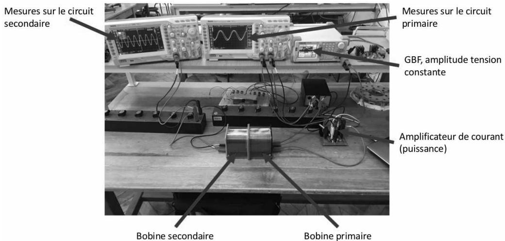
**FIGURE 8** – Photographie légendée du montage expérimental.
