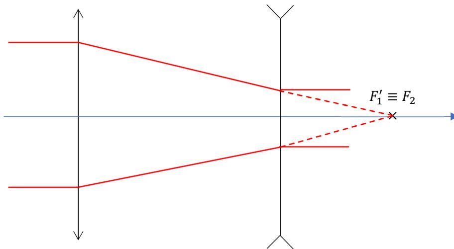
Avec uniquement la lentille  $L_1$  suivie de  $L_2$  le faisceau est nécessairement rétréci (voir schéma)
