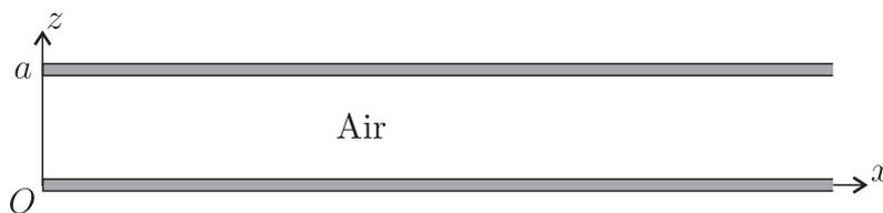
FIGURE 6 – Modèle plan de guide d'onde acoustique.
