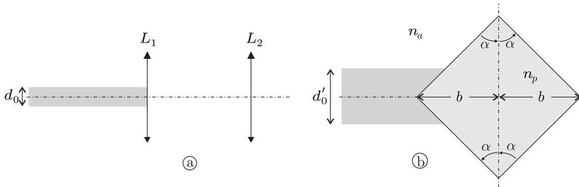
FIGURE 3 – Élargisseur (a) et diviseur de faisceau (b)
