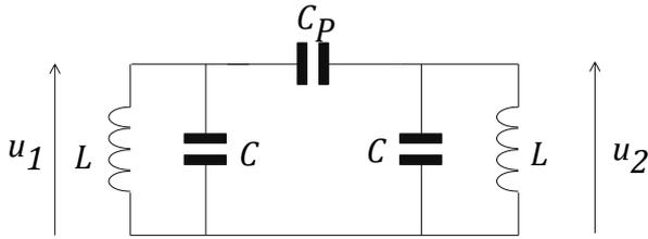
On étudie le régime libre du circuit électrique ci-dessus. On postule l'existence d'un régime permanent sinusoïdal de pulsation  $\omega$  inconnue. Dans le cas où il existe, on peut alors utiliser la notation complexe pour relier les amplitudes complexes  $\underline{u}_1$  et  $\underline{u}_2$  associées à  $u_1(t)$  et  $u_2(t)$ .
