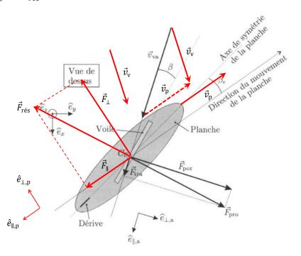
Si  $\beta_{\rm e}=0$ ,  $\vec{F}_{\rm r\acute{e}s}$  est parallèle à  $\vec{v}_{\rm p}$  puisque  $C_{\rm p,\perp}=0$ . La force  $\vec{F}_{\rm r\acute{e}s}$  ne peut donc compenser la force propulsive. Le mouvement rectiligne et uniforme est donc impossible.
