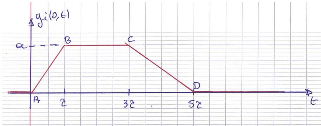
2) Au bout de  $7\tau$ , le point A a parcouru  $7c\tau$  et on place alors les autres points de l'onde. Au bout de  $30\tau$ , l'onde s'est entièrement réfléchiée, le point A est au milieu de la corde.
