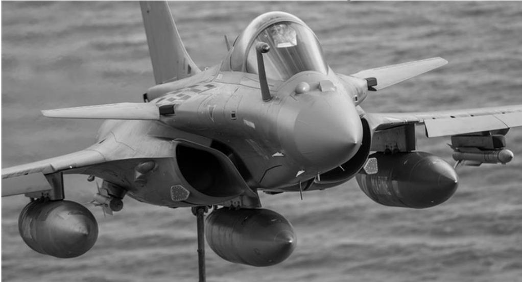
Sur le Rafale ci-dessus, on voit très bien l'entrée d'air droite qui semble écartée du fuselage, tout simplement pour éviter la couche limite. L'entrée d'air a été calculée pour limiter la signature radar.
