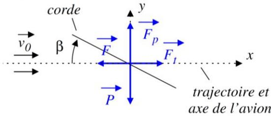
En mouvement uniforme, la somme des forces est nulle. On a  $F=F_t$  et  $P=F_p$ .
