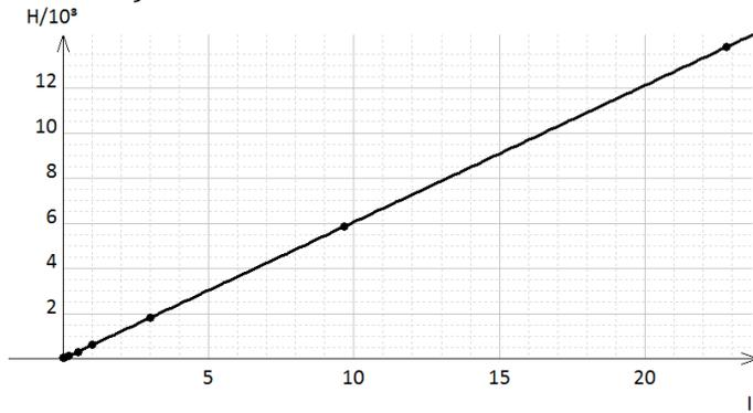
On obtient par régression,  $H=aI$  avec  $a=605\text{m}^{-1}$ .
