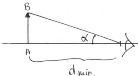
On calcule  $|\alpha|=|AB|/d_{min}$  et  $|\alpha'|=|A_1B_1|/f'_2$
