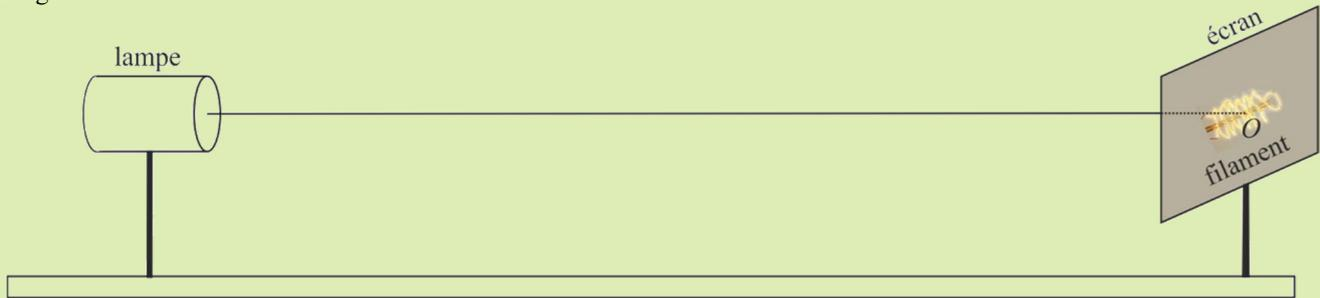
— Les lentilles, lunettes, etc. doivent être alignées verticalement afin de travailler dans les conditions de Gauss. On peut réaliser cet alignement avec une règle ou en prenant une lunette comme hauteur de référence.
