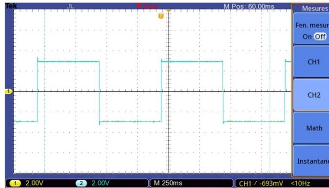
À 1 Hz, on a en première approximation  $V_s = V_e$  car pour les harmoniques de fréquences inférieures à 200 Hz, on a  $H \approx 1$ . Cependant, les harmoniques de fréquences situées autour de  $f_{rés.} \approx 1000$  Hz sont amplifiés et créent des oscillations au voisinage des discontinuités de  $V_e$ . Ce sont les oscillations étudiées au 3., dont la durée est très faible devant la période de  $V_s$ .
