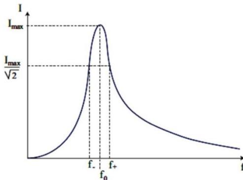
L'étude expérimentale de la résonance en intensité d'un circuit RLC série en régime sinusoïdal permanent avec un GBF délivrant une tension sinusoïdale d'amplitude  $E=10V$  et de fréquence  $f$  ajustable a permis d'obtenir la courbe ci-dessus où  $I$  est la valeur efficace du courant en fonction de la fréquence.
