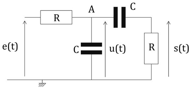
On se place en RSP de pulsation  $\omega$  et on garde la notation complexe. On s'intéresse à la fonction de transfert  $\underline{H} = \frac{S}{E}$ .
