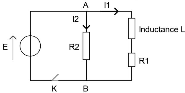
1) A l'instant  $t=0$ , on ferme l'interrupteur  $K$ . Calculer les courants  $I_1$  et  $I_2$  pour  $t \rightarrow 0^+$  et pour  $t \rightarrow +\infty$ .
