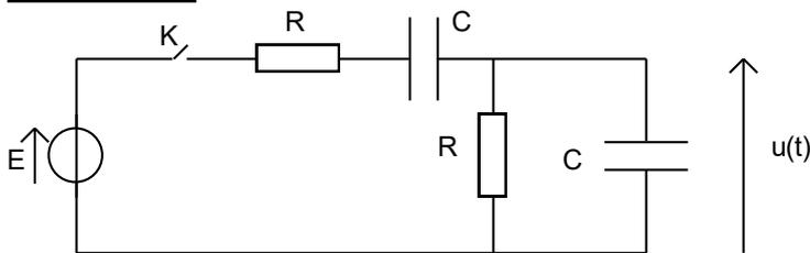
$E$  désigne un générateur de tension continue et on note  $i(t)$  le courant fourni par le générateur au circuit. On donne  $R=1k\Omega$  et  $C=1\mu F$
