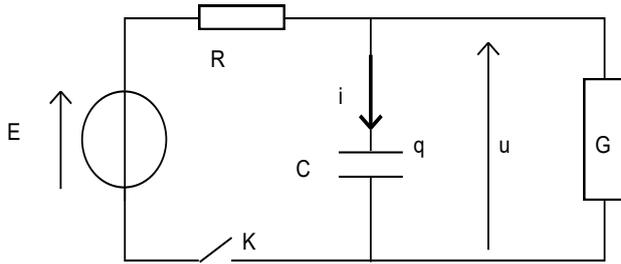
$G$  se comporte comme une résistance infinie jusqu'à sa tension d'allumage  $E_a=80V$ . Dès que le tube est allumé, il se comporte comme une résistance  $R'$  tant que sa tension reste supérieure à sa tension d'extinction  $E_e=60V$ .
