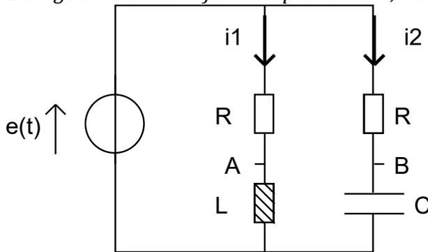
On pose  $e(t)=E\cos(\omega t)$  ;  $i_1(t)=I_1\cos(\omega t+\varphi_1)$  ;  $i_2(t)=I_2\cos(\omega t+\varphi_2)$  .
