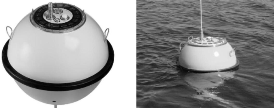
Figure 1 Photographies d'une bouée houlographe Waverider
