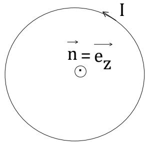
Le dessin ci-dessus est absolument nécessaire. A l'extérieur du solénoïde, le champ magnétique est nul. A l'intérieur, il vaut :  $\vec{B} = \mu_0 n I \vec{e}_z$  et il est uniforme.
