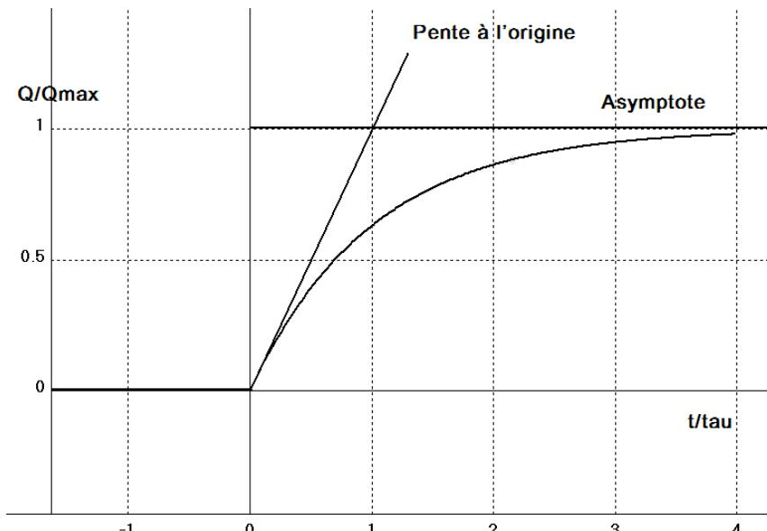
6.3) Pendant  $dt$ , le générateur fournit la charge  $dQ = idt$  sous la tension  $U_0$ . L'énergie fournie est donc  $dW_1 = U_0 \cdot i \cdot dt = U_0 dQ$  qu'on peut intégrer de l'état initial ( $Q=0$ ) à l'état final ( $Q=CU_0$ ) et on obtient  $W_1 = CU_0^2$ .
