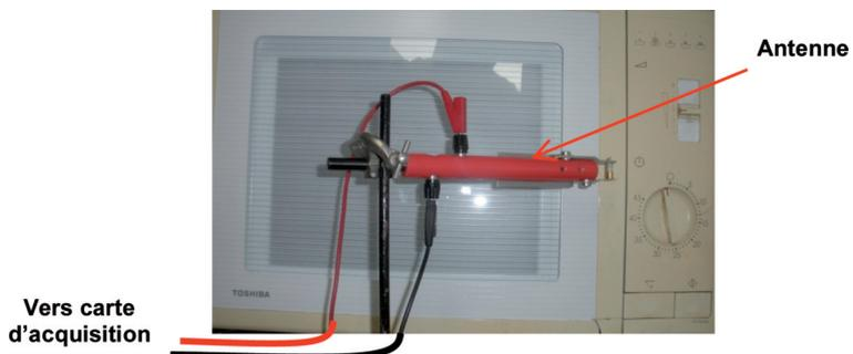
Figure 16 : Acquisition du signal produit par un four à micro-ondes.
