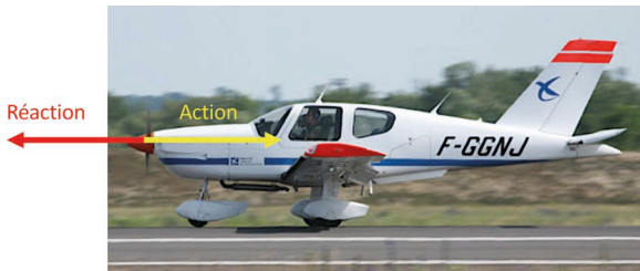
Figure 6 - Principe des actions réciproques appliqué à l'hélice en rotation.
