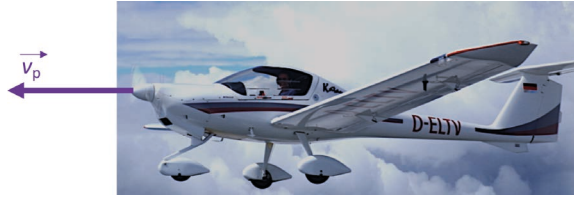
Figure 21 - Vecteur vitesse propre d'un avion en vol palier à vitesse constante.
