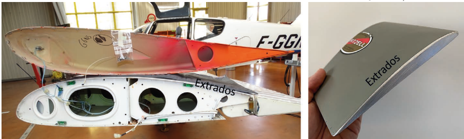
Figure 3 - Comparaison du profil d'une aile d'avion et d'une pale d'hélice.
