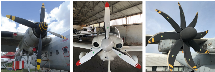
Figure 7 - Différents types d'hélices (à droite, hélice de l'A400M).
