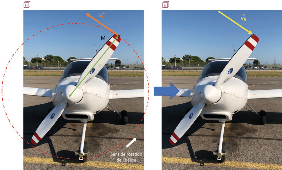
Figure 20 - (A) Vecteur vitesse tangentielle - (B) Vecteur vitesse vent relatif.
