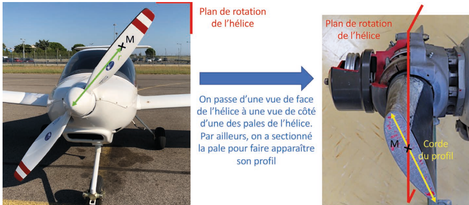
Figure 23 - Représentation de la section de pale d'une hélice pour l'étude des forces.
