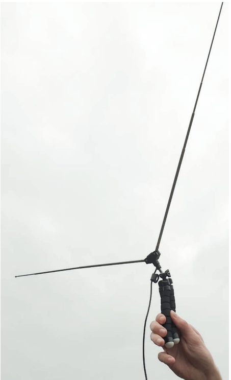
Figure 5 - A Antenne dipôle en V, simple et efficace ! - B « Double cross antenna » qui a peu servie de par son encombrement et le faible gain apporté au final.
